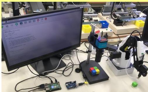
【カメラを使い、良品・不良品をAIで判断し、ロボットハンドが分別する新技術】
